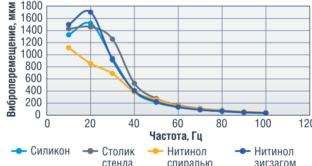
РИСУНОК 8. Изменение виброперемещения при разных частотах для полимеров с армированием
