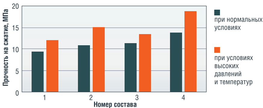
РИСУНОК 1. Результаты исследования прочностных характеристик при нормальных условиях и при условиях высоких давлений и температур [15]
