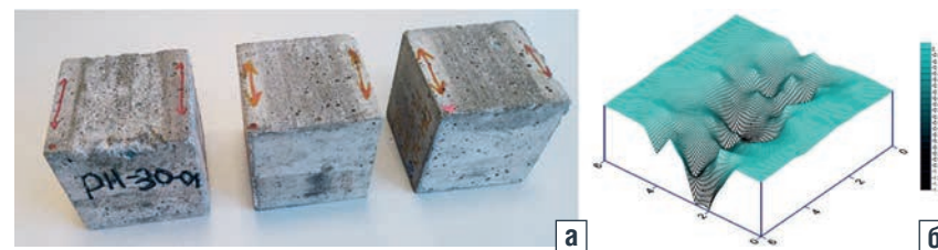
РИСУНОК 2. Истертые образцы бетона (а) и оцифрованная истертая поверхность по результатам испытания (б) [12]
