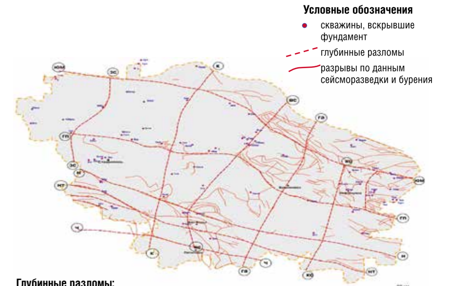
РИС. 1. Схема дизъюнктивной нарушенности фундамента
