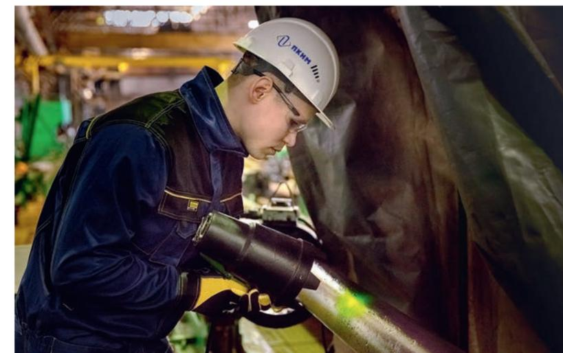
буровых труб с целью их подготовки к проведению инспекции, после чего специалисты Лаборатории неразрушающего контроля определяют наличие дефектов и критического износа оборудования.
