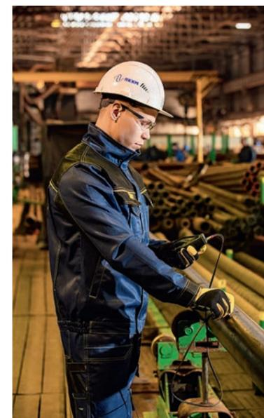
Проведение ультразвуковой дефектоскопии на нашем предприятии можно условно разделить на три блока:
