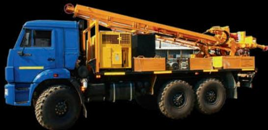
Предназначена для бурения геофизических и структурно-поисковых скважин на нефть и газ вращательным способом с очисткой забоя скважины промывкой, продувкой или транспортировкой разрушенной породы на поверхность шнеками.
