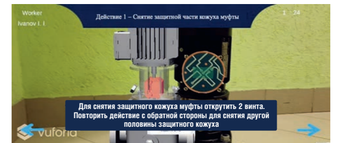
РИС. 10. Снятие двух половинок сцепления
