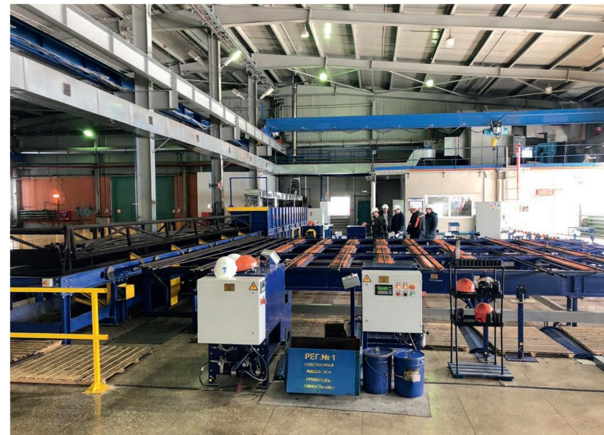
достаточный комплекс операций для эффективной диагностики и ремонта труб с учетом актуальных требований стандартов. Участок позволяет производить сервис НКТ всех типоразмеров, в т.ч. технологических труб с износостойкими замками и с внутренним полимерным антикоррозионным покрытием.
