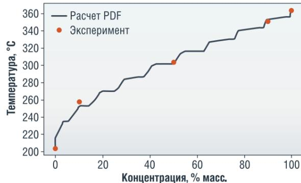
РИСУНОК 45. Рассчитанные и экспериментальные данные по групповому составу
