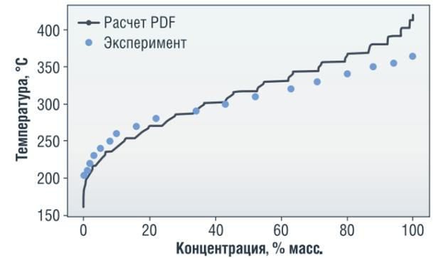
РИСУНОК 23. Рассчитанные и экспериментальные данные по групповому составу
