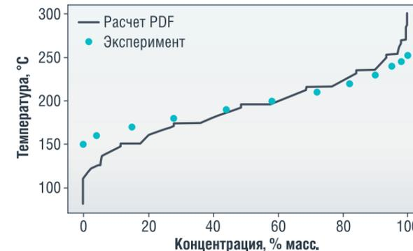
РИСУНОК 52. Рассчитанные и экспериментальные данные по групповому составу
