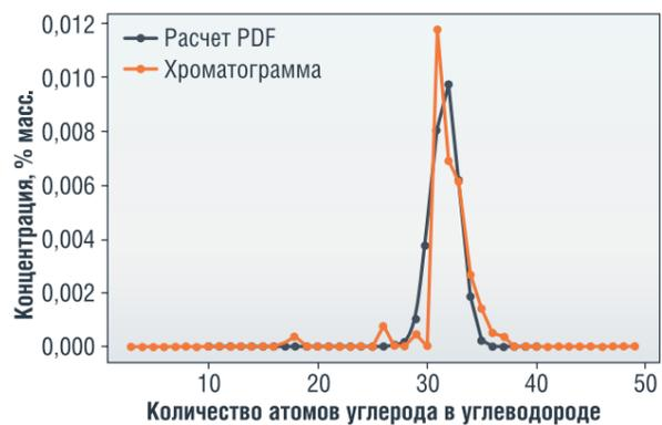
РИСУНОК 16. Рассчитанные и экспериментальные данные по групповому составу
