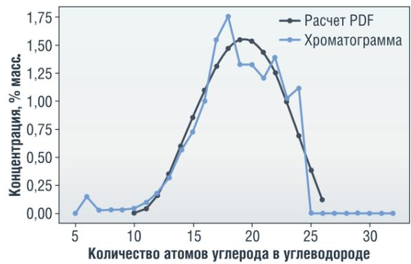
РИСУНОК 18. Распределение изопарафинов
