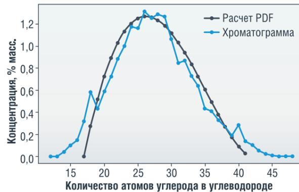
РИСУНОК 4. Распределение изопарафинов
