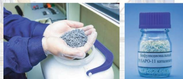
а) гибридный катализатор синтеза углеводородов; б) бифункциональный катализатор гидроизомеризации Pt/SAPO-11
