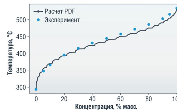
РИСУНОК 10. Рассчитанные и экспериментальные данные по групповому составу
