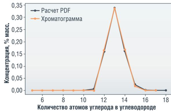
РИСУНОК 29. Рассчитанные и экспериментальные данные по фракционному составу
