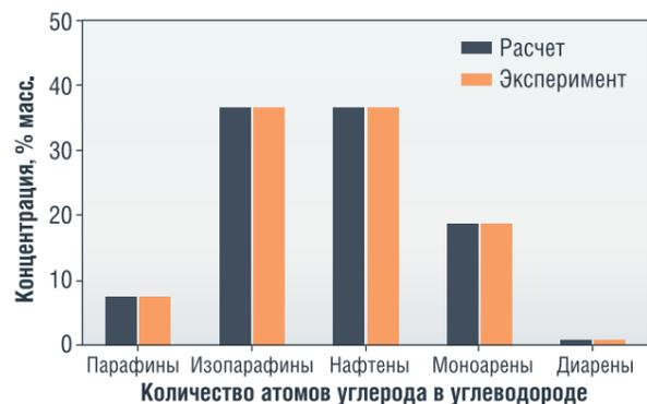
РИСУНОК 37. Рассчитанные и экспериментальные данные по фракционному составу
