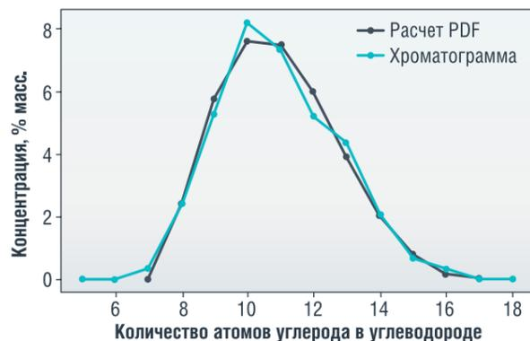
РИСУНОК 44. Рассчитанные и экспериментальные данные по фракционному составу
