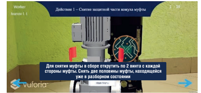
РИС. 9. Снятие кожуха муфты
