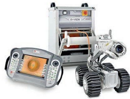
РИС. 8. Мобильная роботизированная система телеинспекции ROVION [16]
