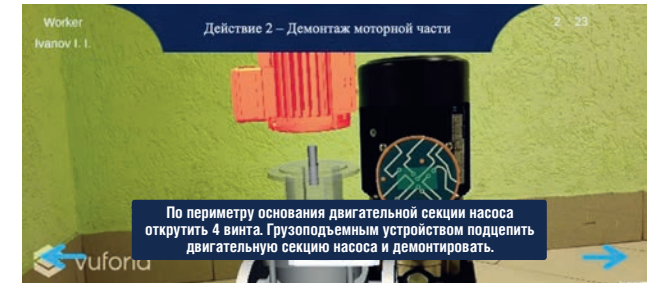
РИС. 12. Демонтаж моторной части
