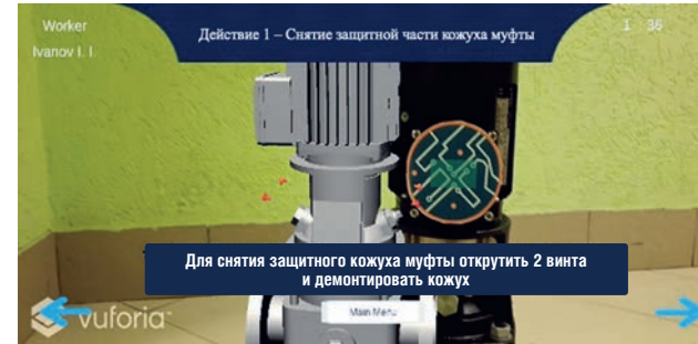
РИС. 8. Отвинтите два винта кожуха муфты
