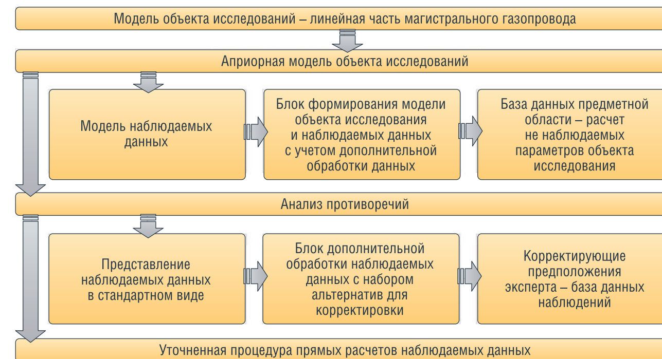
РИС. 1. Структура системы интерпретации результатов наблюдений за ЛЧ МГ
