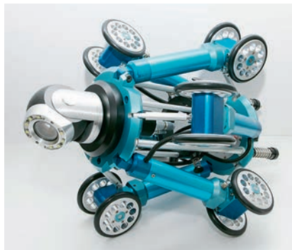
РИС. 7. Краб-робот серии X [14]
