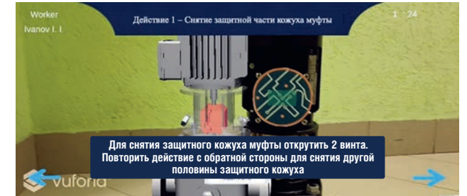
РИС. 10. Снятие двух половинок сцепления
