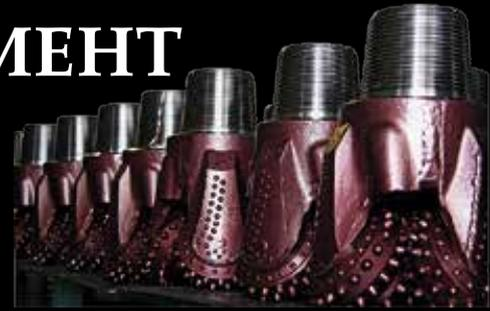
Козырек лапы обычно защищается антиабразивным покрытием. На тыльной части шарошки наплавляют защитное покрытие с хорошо сопротивляющейся абразивному износу калибрующей поверхностью, разделяемой одной из конических поверхностей корпуса шарошки. Вершина первой шарошки выполняется с лопатовидными элементами.
