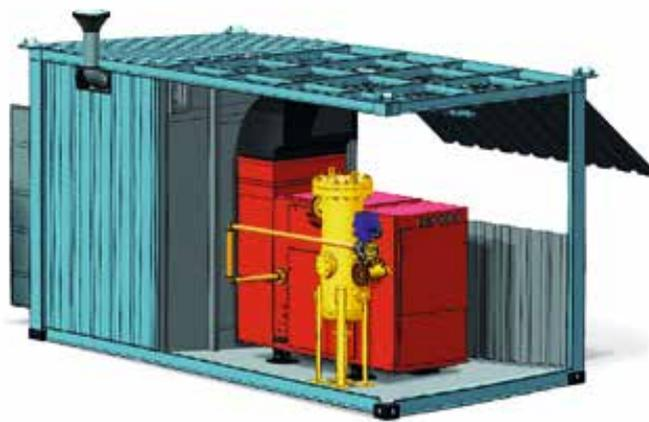
РИС. 2. Макет компоновки блочно-модульной МГКУ в укрытии
