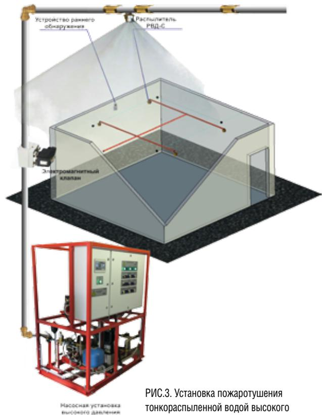
РИС.3. Установка пожаротушения тонкораспыленной водой высокого давления «Бастион-ВД»
