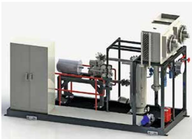
РИС. 1. 3D-модель малой газокomppressorной установки на открытой раме
