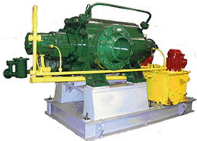
РИС. 5. Насос НДМг 600-320 в процессе производства
