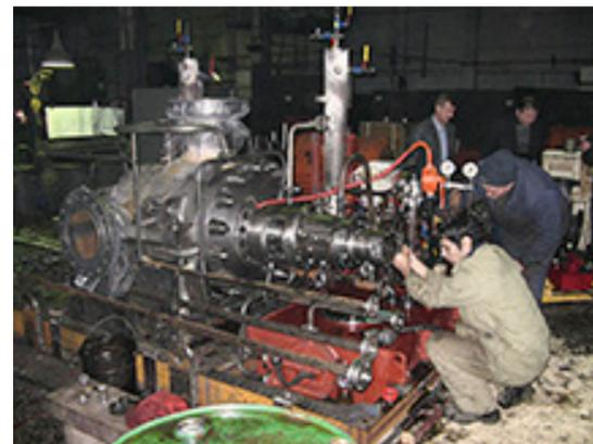
РИС. 4. Насосный агрегат компании «SULZER»
