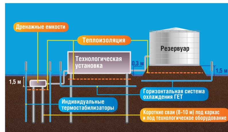
Технологические установки могут располагаться в одном технологическом модуле, где короткие сваи применяются под каркас и тяжелое технологическое оборудование, а резервуары устанавливаются на насыпное
