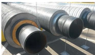
Комплексная антикоррозионная защита МПТ наряду со специальными покрытиями включает термоусадочные манжеты для защиты участков труб с кольцевыми сварными стыками, а также браслетные и короткозамкнутые протекторы на основе алюминиевого или цинкового сплава. На сегодняшний день Регистром одобрено 17 типов манжет. Количество сертифицированных за 2013–2015 гг. браслетных протекторов на трубы диаметром от 168 мм до 720 мм составило порядка 5000 шт.
