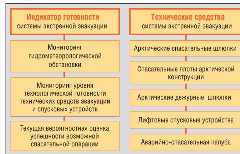
ледовых условий. Внешний корпус лифтового спускового устройства должен быть спроектирован с соответствующим уровнем ледовой защиты и жестко сопрягаться с несущими конструкциями морского сооружения. Подвижная часть должна обеспечивать спуск под действием только гравитационных сил, а подъем подвижной части возможен с использованием бортовых источников энергии.
