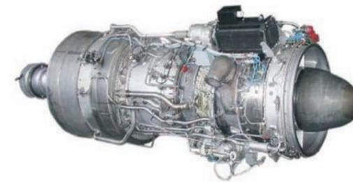
ГТД – трехвалный, предназначен для привода синхронного генератора электростанции, что обеспечивается передачей крутящего момента от ведущего вала свободной турбины через редуктор и валопровод с фрикционной и мембранной муфтами на вал генератора.
