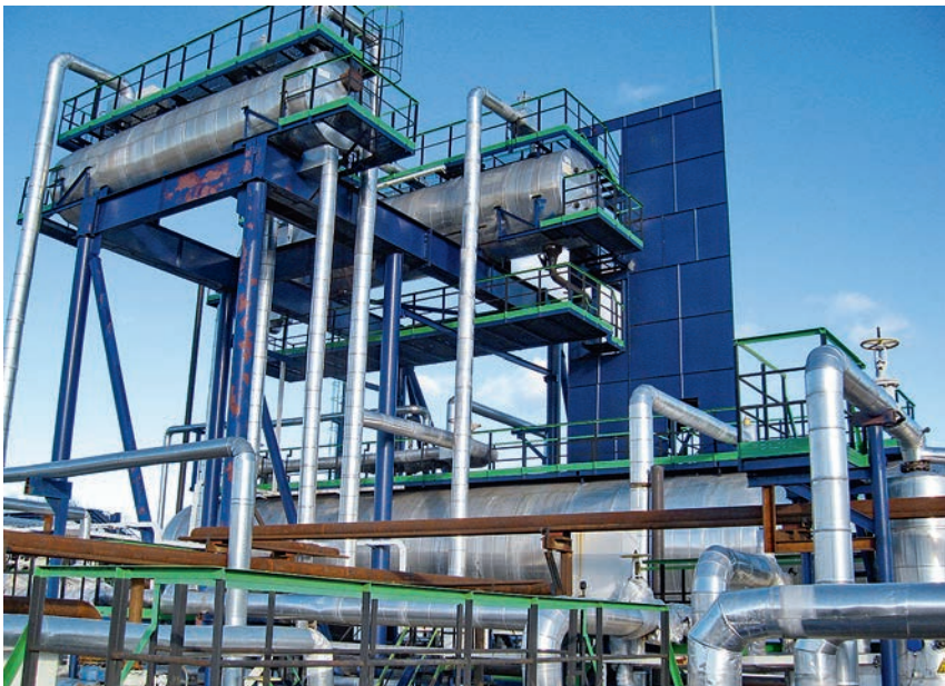
ФОТО 1. Разделительные сепараторы на установке подготовки нефти
