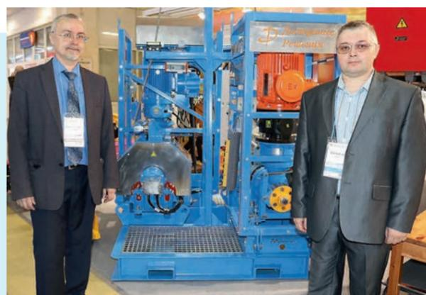
шкафов управления представлены решения как во взрывозащищенном, так и в общепромышленном исполнении. Основная сфера применения данного типа лебедок – нефтегазовые месторождения, они устанавливаются на роторном столе в качестве вспомогательной лебедки. Оборудование широко востребовано и ориентировано на эксплуатацию в диапазоне низких температур. »
