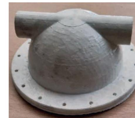
С целью повышения герметичности и механических свойств корпуса, была выполнена пропитка полученных заготовок эпоксидной смолой ЭД-20 с отвердителем Этал-45М.
