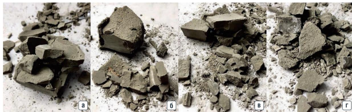
а – образец 6 с содержанием базальта 0,9 г/л; б – образец 7 с содержанием базальта 1,3 г/л; в – образец 8 с содержанием базальта 1,7 г/л; г – образец 9 с содержанием базальта 2,0 г/л
