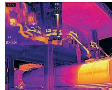
5. Тепловизионные камеры также применяются в целях мониторинга температуры резервуара для хранения. Измерение температуры поверхности резервуара предоставляет информацию для визуального наблюдения за уровнем жидкости и обеспечивает безопасность процесса хранения, позволяя избежать разлива масла и утечки газа, вызванных чрезмерно высоким
