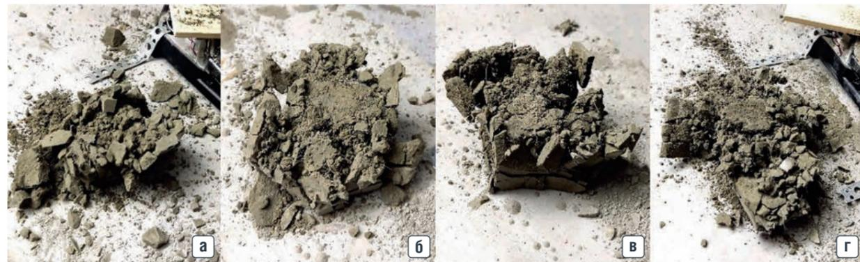
а – образец 2 с содержанием полипропилена 0,9 г/л; б – образец 3 с содержанием полипропилена 1,3 г/л; в – образец 4 с содержанием полипропилена 1,7 г/л; г – образец 5 с содержанием полипропилена 2,0 г/л
