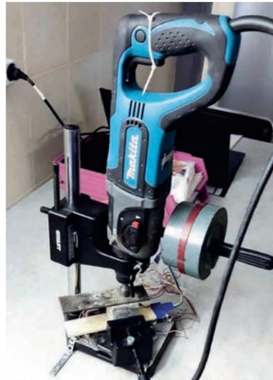
и модернизирована для установки датчиков. При опускании ручки подвижной части станины происходит создание осевой нагрузки на испытуемый образец цементного камня. Для создания постоянной нагрузки используется груз массой 5 кг, при расположении которого на ручке стойки создается усилие в 120 Н. При данных условиях свободный ход ручки вниз составляет 0,015 м, и при ходе ее на это расстояние испытание считается завершенным.
