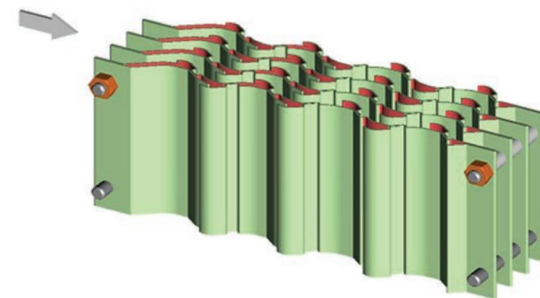
РИСУНОК 17. Конструкция СПП фирма Stein Industrie (Франция)
