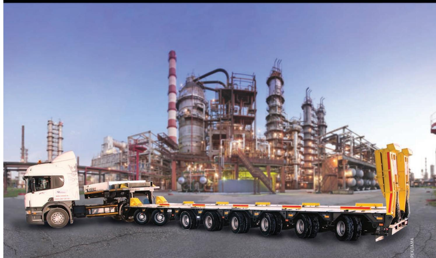
8-осный раздвижной полуприцеп-тяжеловоз с гидробалансирными гусакон и подвеской, а также принудительной системой рулевого управления всех колес, грузоподъемностью 100 т, грузовая площадка от 16 до 30 м, высота платформы 0,9 м.
