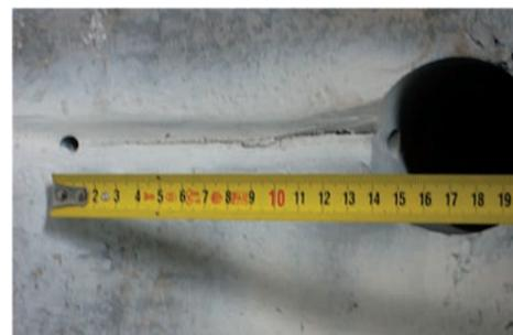
На рисунке 8 показано расположение 46 выборок металла на внутренней поверхности нижней половины корпуса ЦВД турбины К-200-130 после наработки 42 тыс. часов при температуре свежего пара 565°С и 110 тыс. часов при температуре 540°С. Общее число пусков равно 614.
