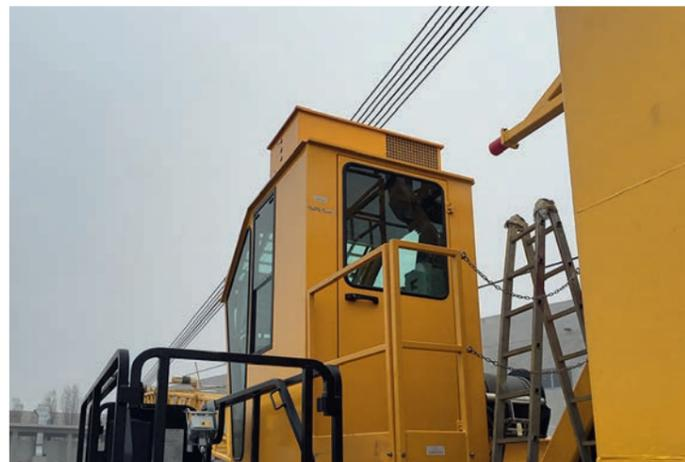
ФОТО 4. Кондиционер для кабины управления краном FPSO
