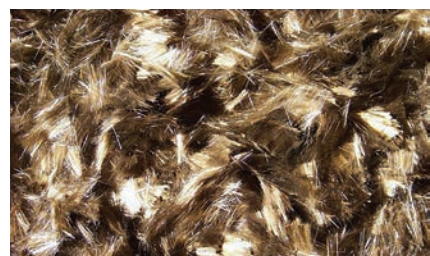
РИС. 3. Базальтовая фибра (цементный раствор с добавлением базальтовой фибры)
