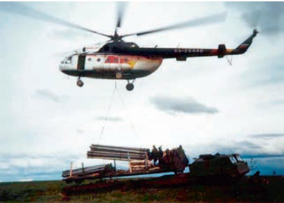
РИСУНОК 10. Доставка труб комплекта СРТ ПМТП-150 вертолетом на трассу нефтепровода «Мусюршор – Сандивей»
