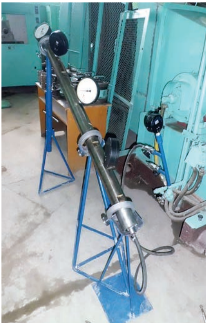
1, 2, 3, 4 – манометры; 5 – верхняя крышка; 6 – нижняя крышка, 7 – труба (с исследуемым составом), 8 – соединительные муфты; 9 – труба для подвода газа
