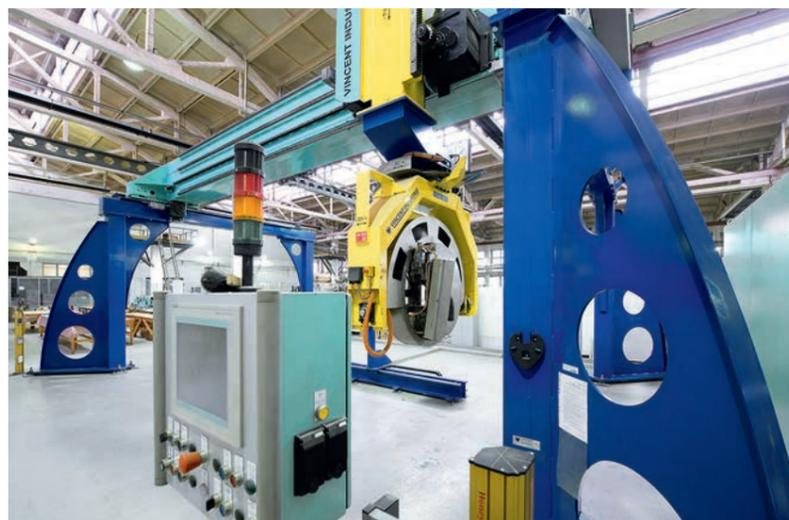
ФОТО 5. Формовочный станок для изготовления катушек
