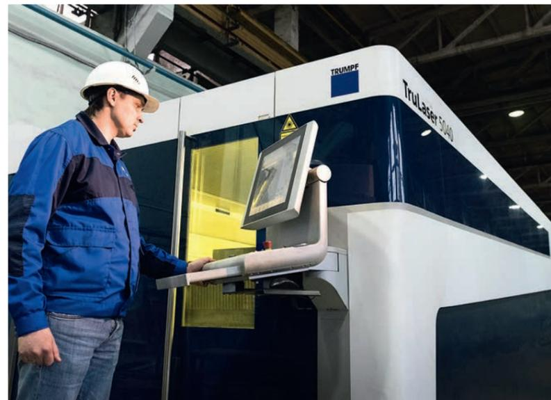
ФОТО 6. Аппарат лазерной резки
