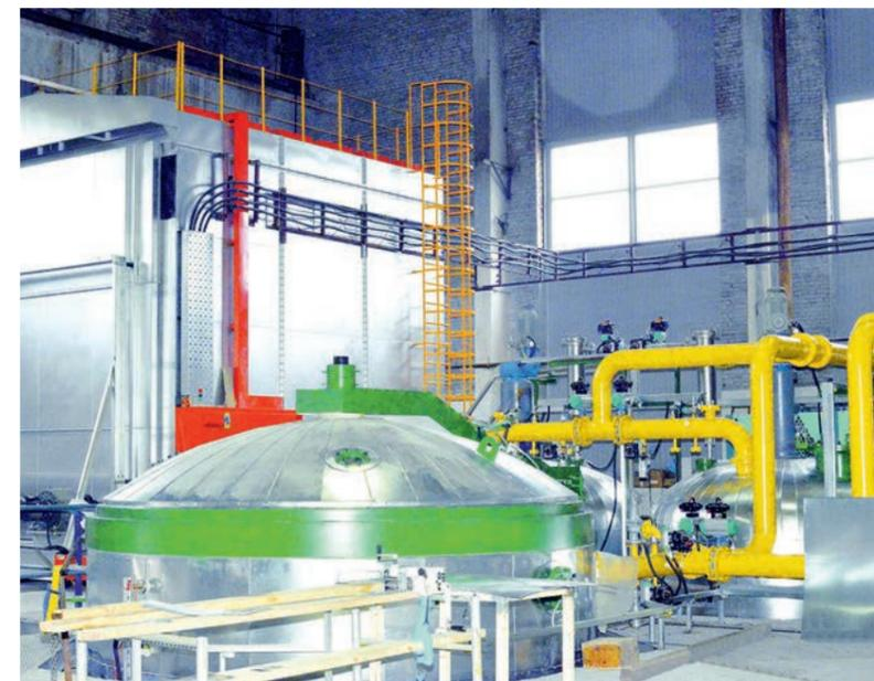
ФОТО 7. Вакуумно-нагнетательный пропиточный комплекс «Монолит»
