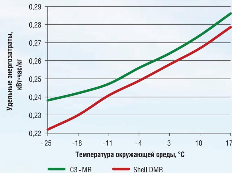
РИС. 3. Зависимость производительности технологических линий сжижения природного газа от изменения температуры окружающей среды
