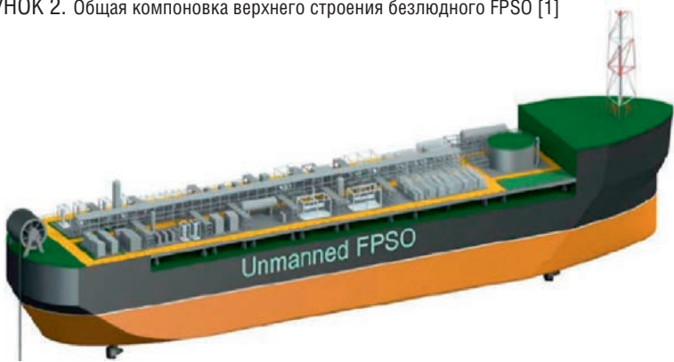
РИСУНОК 2. Общая компоновка верхнего строения безлюдного FPSO [1]
