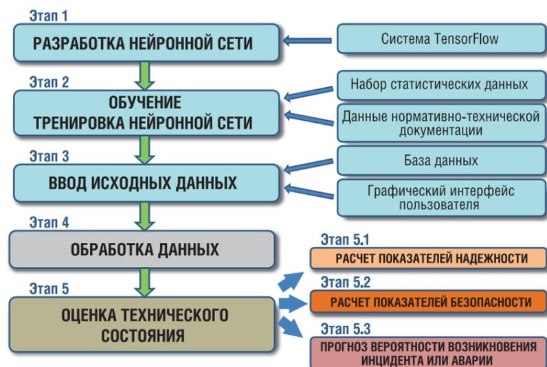
РИС. 1. Схема организации программного комплекса оценки технического состояния ГРС
