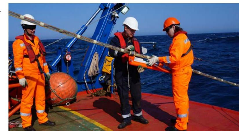
РИС. 2. Выполнение сейсморазведочных работ высокого разрешения (СВР). Установка заглубителя на приемную косу
