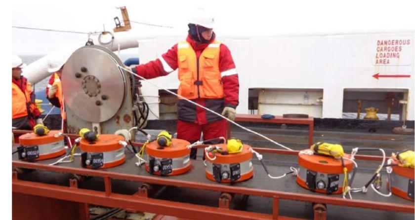
РИС. 5. Выполнение морских сейсморазведочных работы 3D с применением автономных донных регистраторов «Краб», 2019 г.
