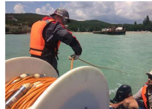
РИС. 4. Испытания автономной донной секционной сейсмокосы в Голубой бухте, 2018 г.
