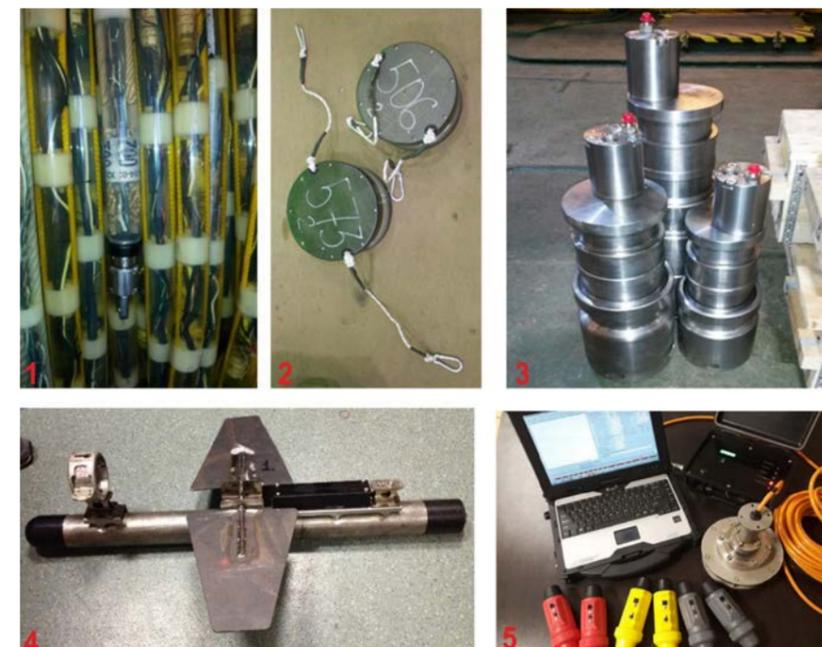
РИС. 1. Образцы испытываемого оборудования: 1 – гелиепополненная буксируемая сейсмическая коса; 2 – автономные донные четырехкомпонентные сейсмические регистраторы; 3 – комплект пневмоисточников различного объема; 4 – система позиционирования и управления глубиной буксировки сейсмодосы; 5 – система акустического позиционирования донных станций.
