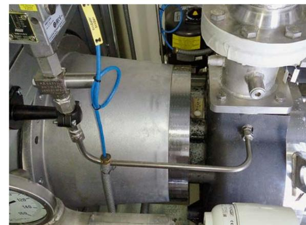
ФОТО 5. Бесконтактное соединение двигателя и компрессора посредством магнитной муфты
