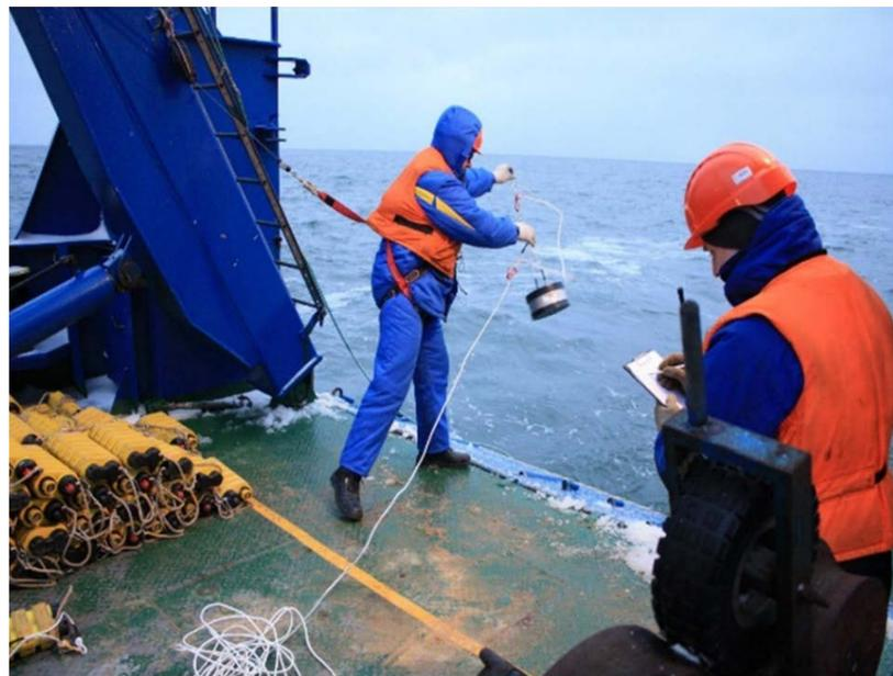
РИС. 3. Раскладка опытных автономных донных регистраторов «Краб» на профиле, 2017 г.
