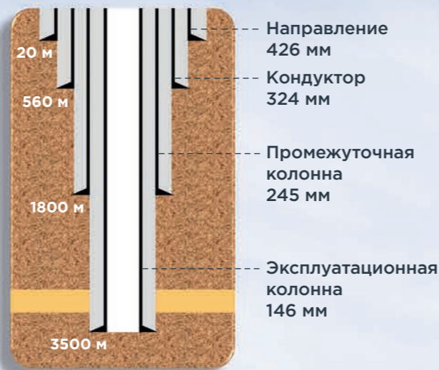
РИСУНОК 1. Пример конструкции скважины
