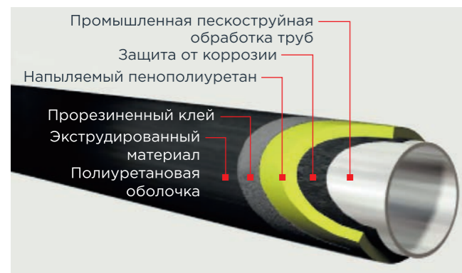
РИСУНОК 3. Слои пенополиуретана на покрытии трубопровода
