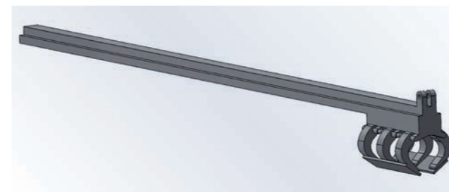
РИСУНОК 14. Выдвижной механизм для захвата трубы, установленной в столе ротора
