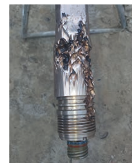
РИСУНОК 2. Повреждение корпуса гамма-модуля из экспериментального материала
