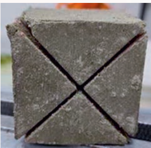
РИСУНОК 2. Реакция ЦК, содержащего СВЦ, с углеводородной жидкостью
