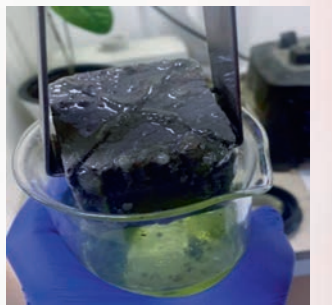
РИСУНОК 2. Реакция ЦК, содержащего СВЦ, с углеводородной жидкостью
