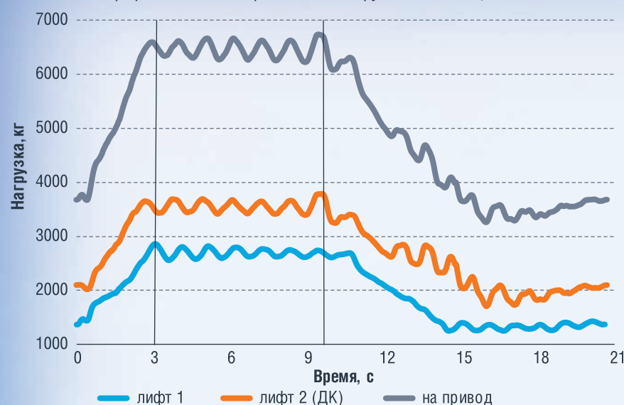
РИСУНОК 4. Графики изменения фактических нагрузок в течение цикла на скважине
