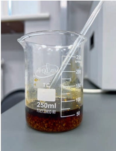
РИСУНОК 1. Образование структуры блокирующего состава
