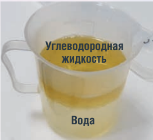
РИСУНОК 1. Реакция СВЦ с углеводородной жидкостью
