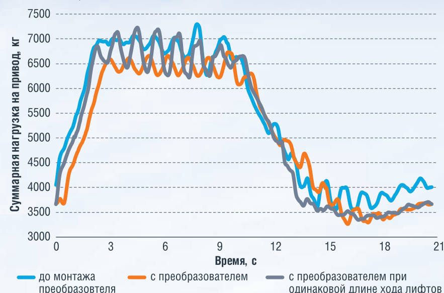
РИСУНОК 5. Сравнение графиков изменения суммарных нагрузок на головку балансира СК в течение цикла
