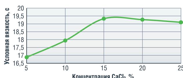
РИСУНОК 6. Изменение условной вязкости для необработанных растворов в зависимости от концентрации \text{CaCl}_2
