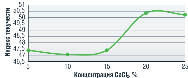
РИСУНОК 2. Изменение индекса текучести для необработанных растворов в зависимости от концентрации \text{CaCl}_2
