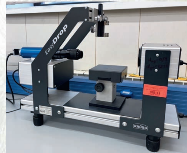
РИСУНОК 1. Прибор для исследования ПАВ тензиометр Easydrop
