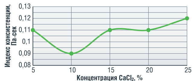
РИСУНОК 3. Изменение индекса консистенции для необработанных растворов в зависимости от концентрации \text{CaCl}_2
