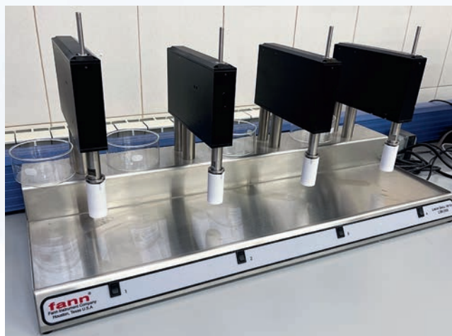
РИСУНОК 2. Тестер линейного набухания глин LSM 2100
