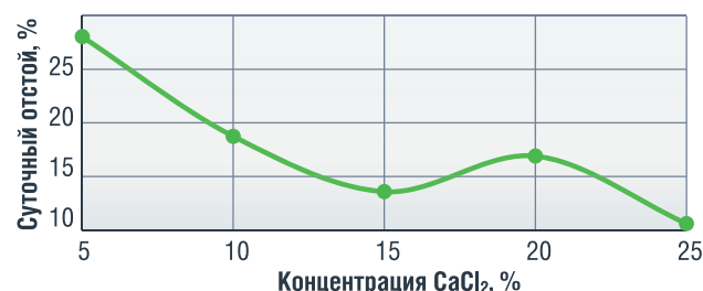
РИСУНОК 1. Изменение суточного отстоя для необработанных растворов в зависимости от концентрации \text{CaCl}_2
