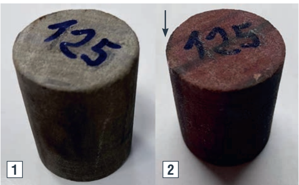
а – внешний вид образца; б – до (1) и после (2) проведения эксперимента по фильтрации окрашенного полимерного раствора ксантановой камеди
