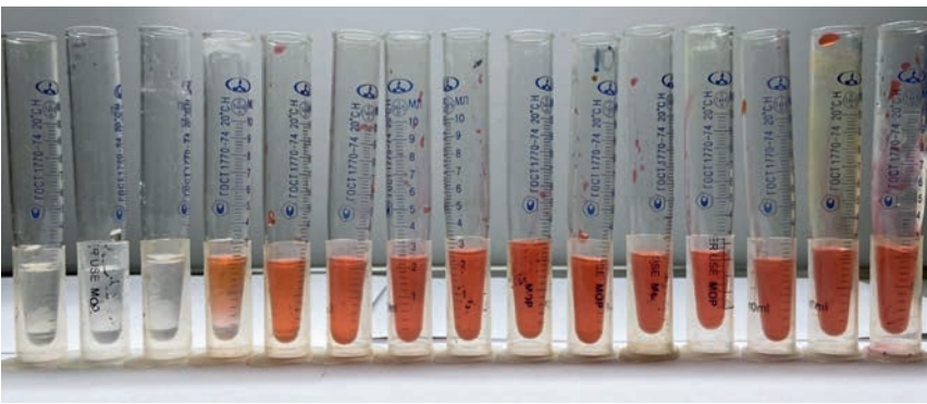
а – внешний вид образца; б – до (1) и после (2) проведения эксперимента по фильтрации окрашенного полимерного раствора ксантановой камеди
