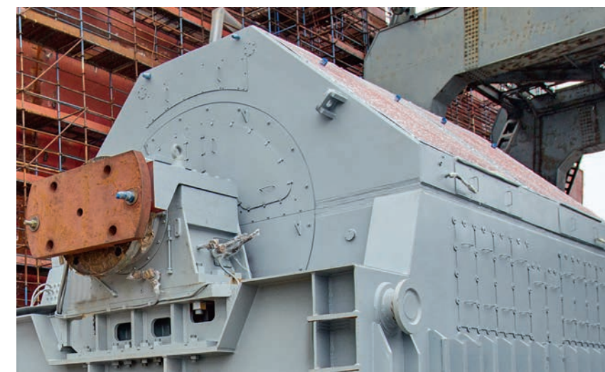
ФОТО 1. Гребной электродвигатель для новейших атомных ледоколов – гигант весом 300 тонн
