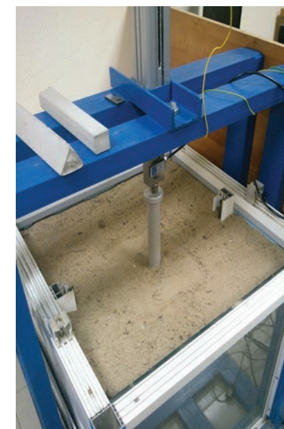
РИС. 4. Лабораторный стенд для изучения усилий, возникающих в процессе погружения / извлечения моделей свай различной конструкции
