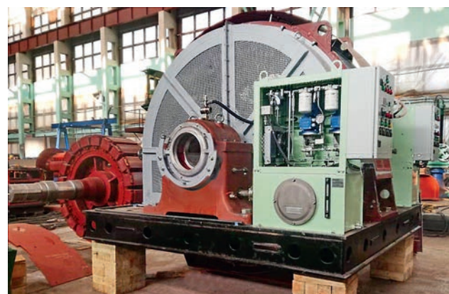
ФОТО 6. Гидрогенератор для Барсучковской малой гидроэлектростанции
