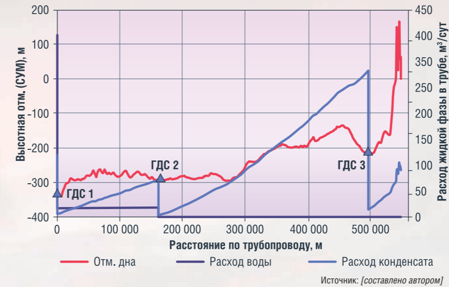
РИСУНОК 10. Точки установки ГДС вдоль трассы трубопровода, расходы конденсата и воды по длине трубопровода
