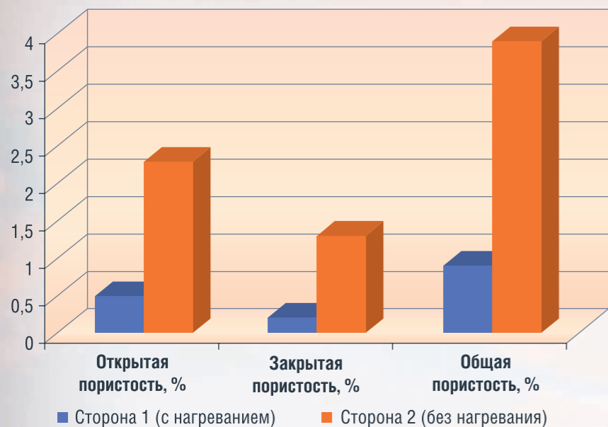
РИСУНОК 1. Результаты исследования пористости с добавлением микросиликатов
