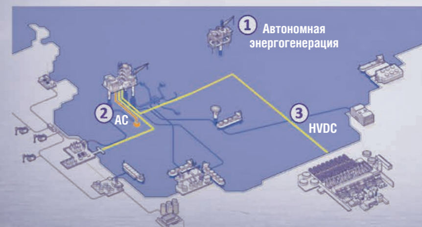
РИСУНОК 1. Основные способы энергоснабжения объектов обустройства морских месторождений
