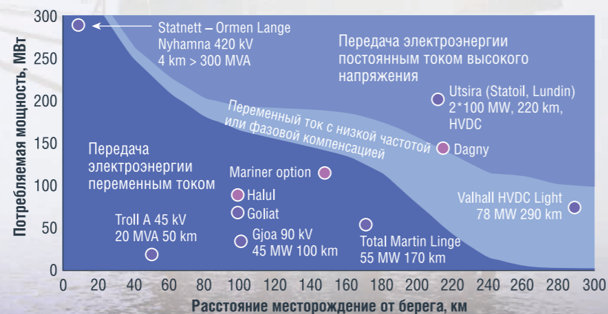
РИСУНОК 4. Области применения различных типов систем электроснабжения [4]
