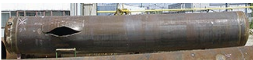
РИС. 2. Общий вид трубы после испытания
