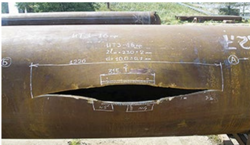
РИС. 1. Вид поверхности разрушения трубы от исходного надреза
