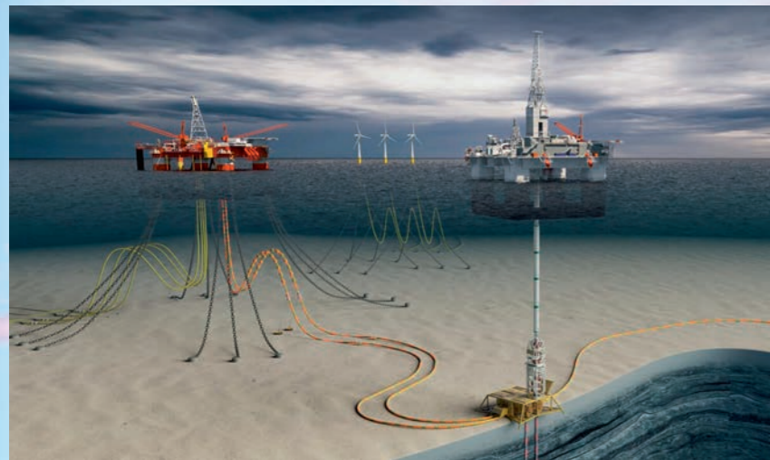
РИСУНОК 2. Пример использования нефтедобывающего судна FPSO для добычи нефти на шельфе
