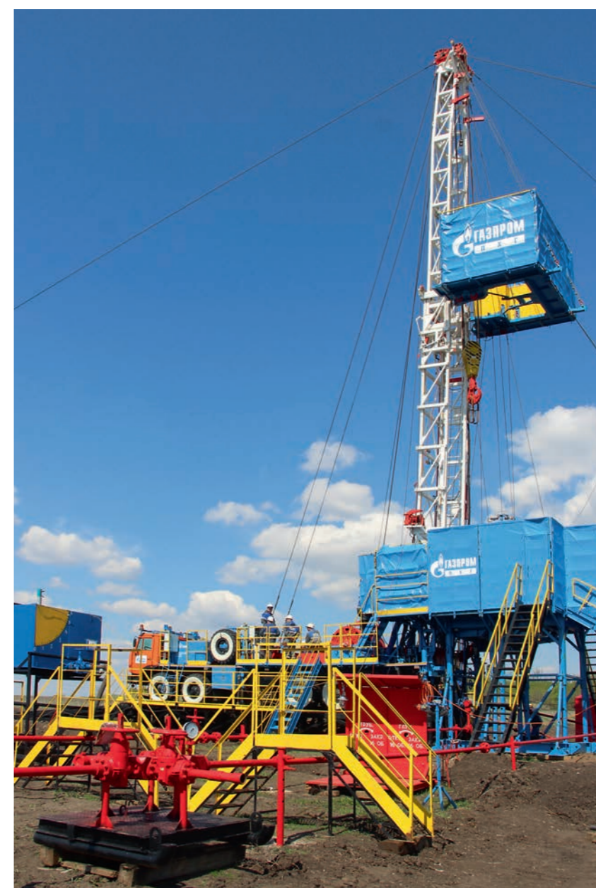
РИСУНОК 6. Подъемный агрегат (80 т) отечественного производства
