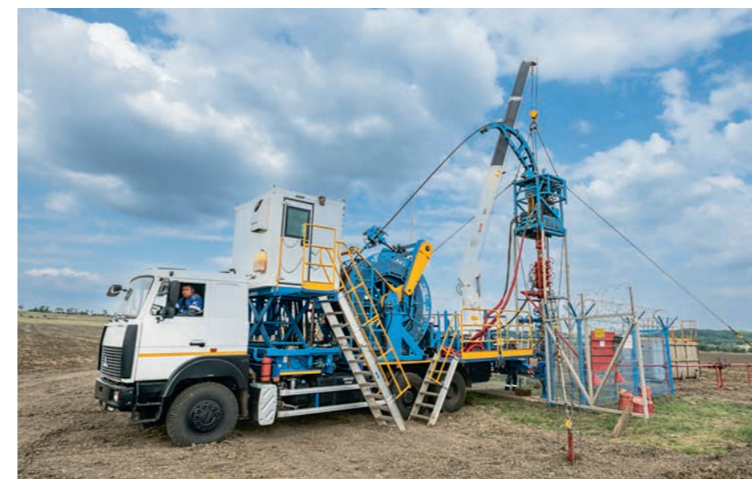
РИСУНОК 5. Колтубинговая установка отечественного производства
