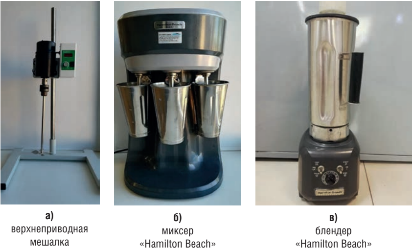
РИС. 1. Оборудование для приготовления буровых растворов
