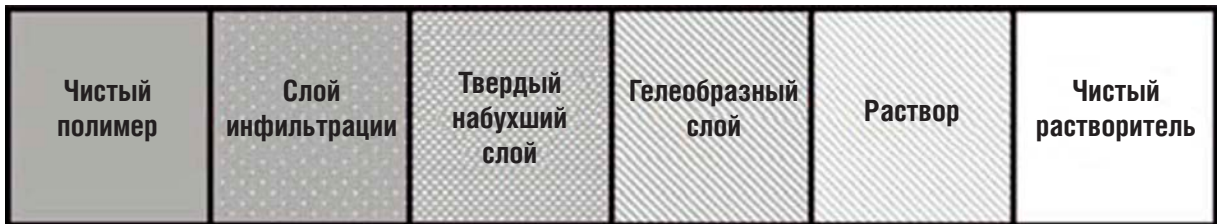
РИС. 3. Слои, образующиеся в процессе растворения полимера
