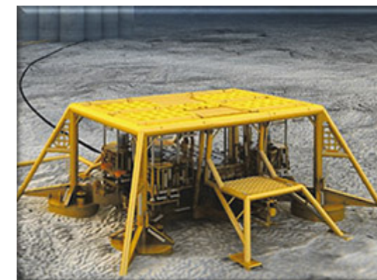
б – подводный модуль с защитной конструкцией на дне моря
