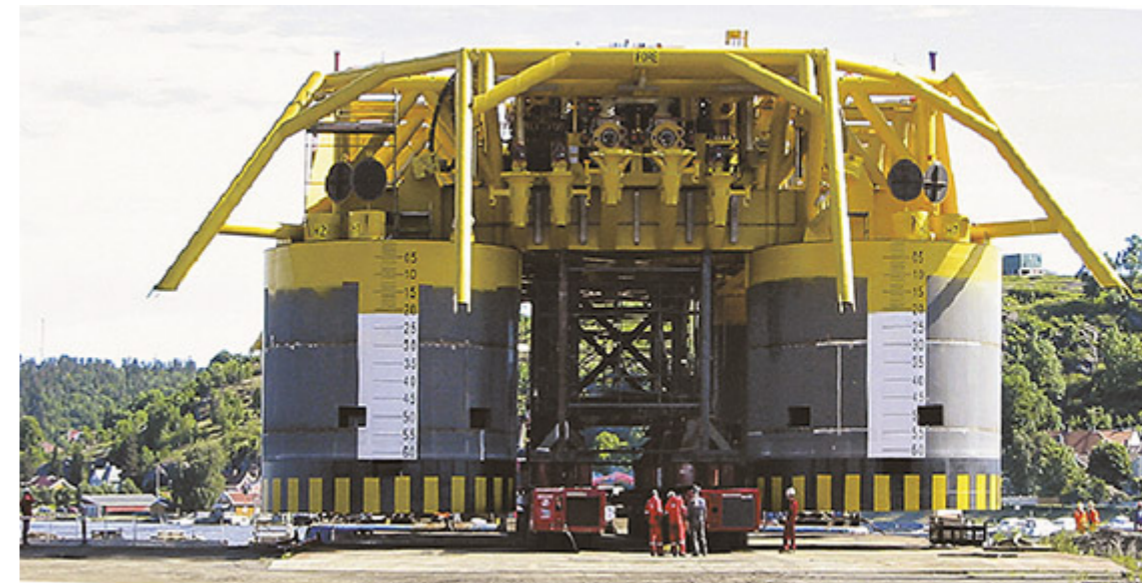
РИС. 5. Подводный модуль на 8 скважин компании FMC Technologies для месторождения Ormen Lange
