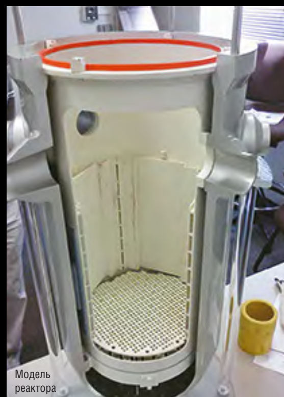
Регенераторы применяют в процессах риформинга и крекинга
