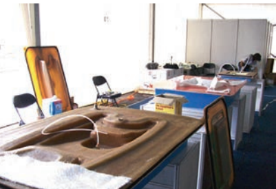
ФОТО 5.1, 5.2, 5.3. Вакуум пресс-формы для формовки композитных изделий сложной конфигурации
