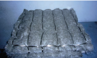
ФОТО 3.3. Прошивной мат БСТВ с обкладками иглопробивным холстом БНВ
