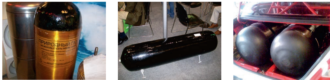
ФОТО 8. Автомобильные БНВ-композитные CNG баллоны высокого давления (60, 120 и 90 литров)
