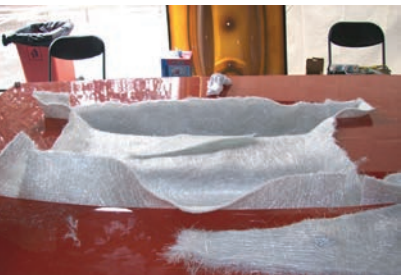
ФОТО 5.1, 5.2, 5.3. Вакуум пресс-формы для формовки композитных изделий сложной конфигурации
