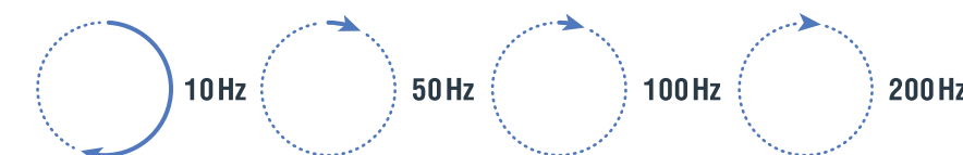
РИСУНОК 3. Угловое смещение бурильной колонны при различных частотах дискретизации
