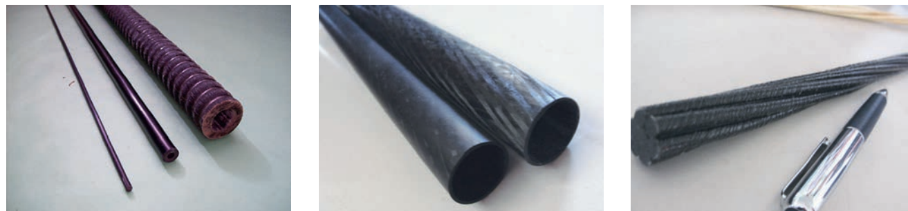
ФОТО 9. Продольные профильные композитные материалы на основе БНВ: прутки, полая арматура, трубки малых диаметров, вантовые тросы
