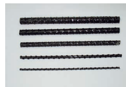
ФОТО 10.3. Арматура БНВ диаметрами 4, 6, 8, 10, 14 мм
