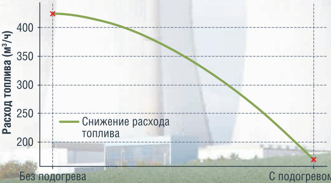
РИСУНОК 5. Снижение расхода топлива при использовании солнечного подогрева воздуха
