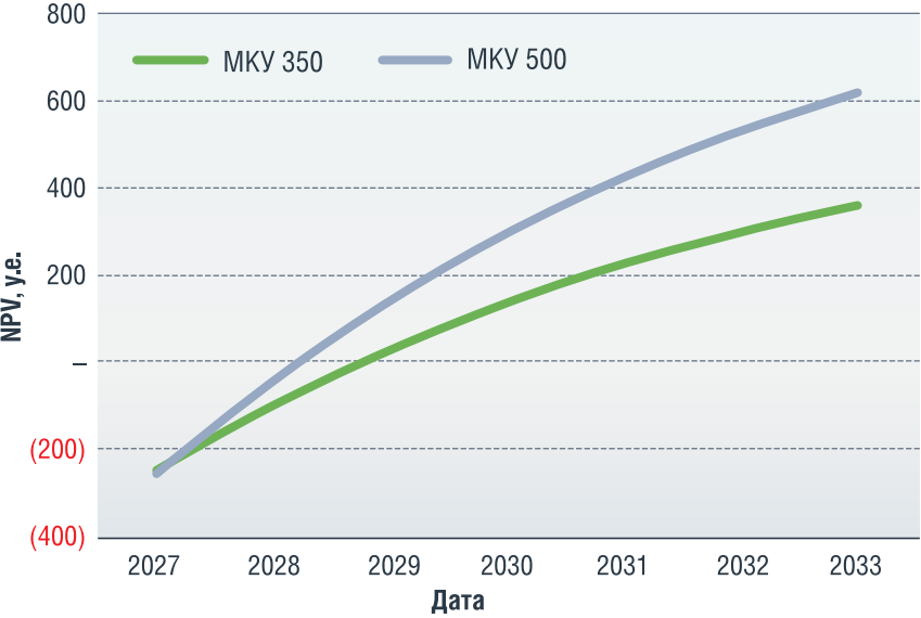
РИСУНОК 7. Динамика изменения NPV при использовании одной МКУ для производительностей по газу 350 и 500 тыс. м³/сут
