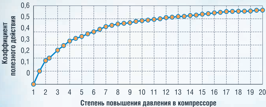
РИСУНОК 1. Зависимость КПД идеальной ГТУ от СПДК
