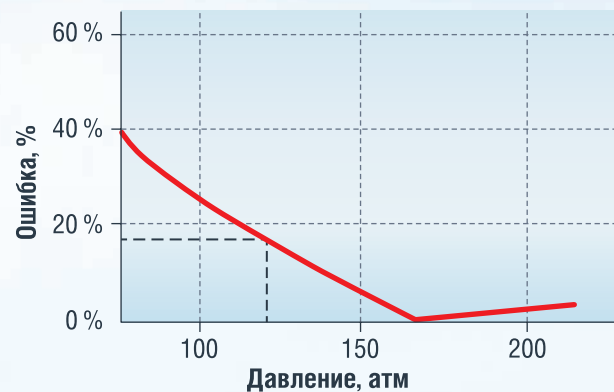
РИСУНОК 1. Ошибка при расчете компенсации стационарным методом в сравнении с динамическим методом
