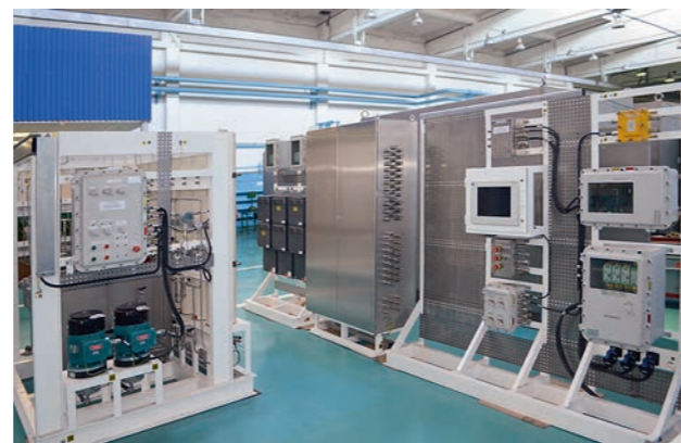
РИС. 1. Станция управления СУФА77 в процессе изготовления
