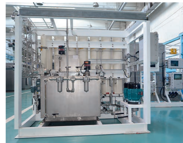
РИС. 2. Насосно-аккумуляторная установка станции управления СУФА77
