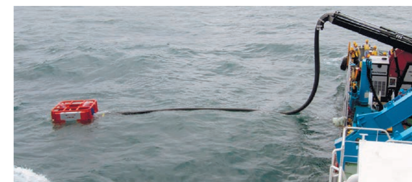
РИС. 3. Применение олеофильного скиммера
