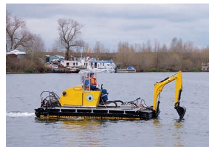
РИС. 4. Работа вездеход-амфибии на водоеме
