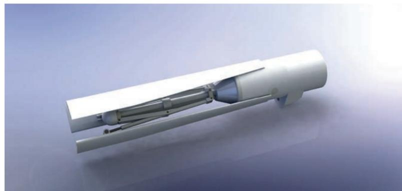
армированный стекловолокном на 40% (для получения необходимых прочностных характеристик и с показателем морозостойкости до -140 °C). Выбранный композит имеет следующие преимущества:
