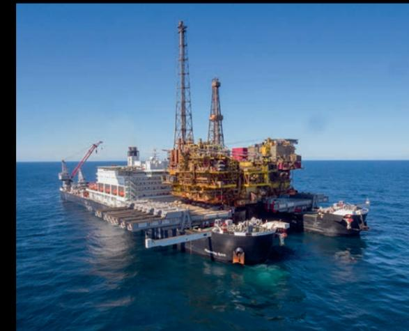
В процессе работы использует якорь или систему динамического позиционирования, предназначенную для удержания судна в заданной позиции и (или) на заданном курсе с целью следования вдоль заданного маршрута автоматически с высокой точностью посредством использования судовых движителей и подруливающих устройств для поддержания правильного положения и скорости при прокладке трубы.
