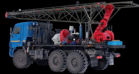
Установка разведочного бурения смонтирована на автомобиле КамАЗ-4310 и включает мачту 3 с кронблоком 1 и вертлюгом 2, буровой насос 4, гидравлический домкрат подъема мачты 5, электрооборудование 6, пневмосистему 7, главную трансмиссию, механизм подачи, устройство для шнекового бурения, коробку передач, лебедку, устройство для развинчивания труб, ротор и систему управления.
