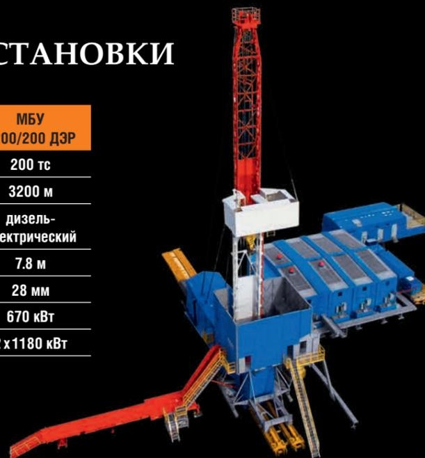
с дизельным, дизель-электрическим или электрическим регулируемым приводом основных механизмов с системой управления с пульта бурильщика. В зависимости от требований заказчика мобильные буровые установки оснащаются циркуляционной системой объемом от 120 до 250 куб. м и различными наборами вспомогательного и очистного оборудования. ●
