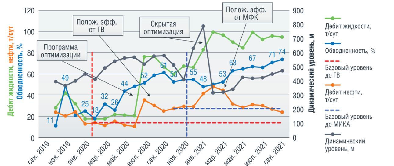
РИСУНОК 7. Фактическая динамика дополнительной добычи нефти по участку за период реализации ОПИ (диаграммы разного цвета – добывающие скважины опытного участка)
