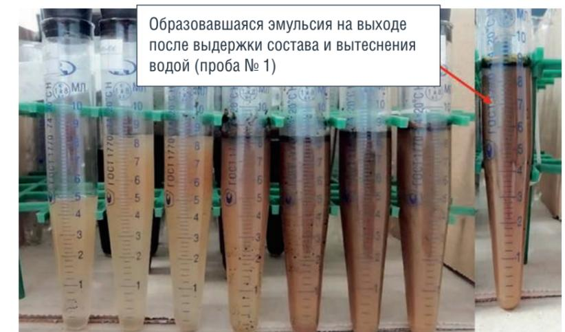
РИСУНОК 4. Результаты фильтрационного эксперимента по оценке коэффициента вытеснения на полноразмерной керновой модели при ступенчатом увеличении температуры
