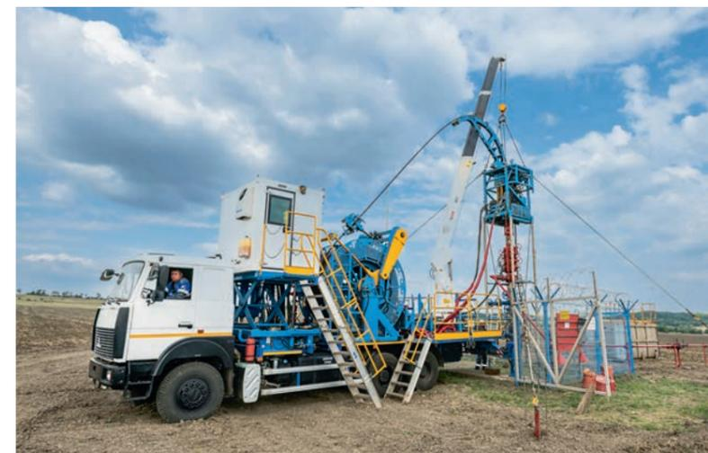
РИСУНОК 6. Подъемный агрегат (80 т) отечественного производства
