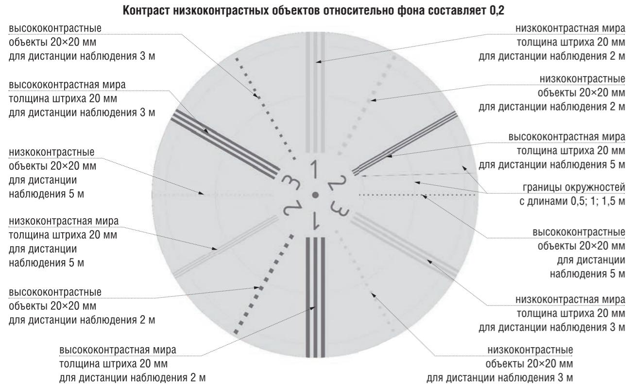
Суть методики испытаний состоит в том, чтобы создать в лабораторных условиях в воздухе такую освещенность объектов наблюдения, которая была бы аналогичной для объектов наблюдения в водной среде при заданных дистанциях наблюдения и относительной прозрачности воды, а также обеспечить перемещение объектов наблюдения в диапазоне скоростей хода АНПА.
