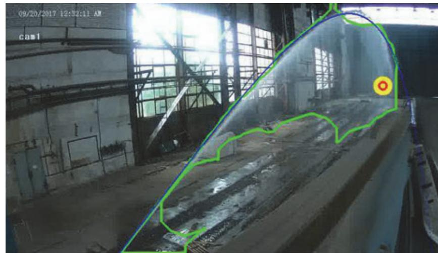
В результате достигнута хорошая степень совпадения реальных и расчётных траекторий струй. Расчетные траектории могут использоваться как для определения зон орошения, так и для определения угла наведения по заданным координатам. Программа «Баллистика», приведенная на сайте firerobots.ru, широко используется проектировщиками разных организаций.
