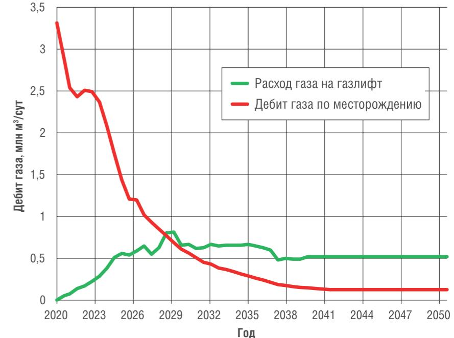
способа добычи приходится на 2032–2038 гг., и варьирует в пределах 0.9–1.1 млн м<sup>3</sup>/сут. Как следует из прогнозного баланса газа (рисунок 8), пиковая потребность газа для газлифта приходится на период резкого снижения уровня добычи газа, что предполагает привлечение дополнительных объемов газа других объектов разработки или месторождений.
