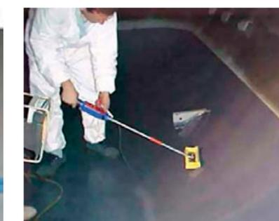
РИС. 5. Инспекция покрытия низковольтным дефектоскопом на сплошность
