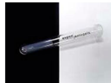
РИС. 3. Аэрогель или «твердый воздух»
