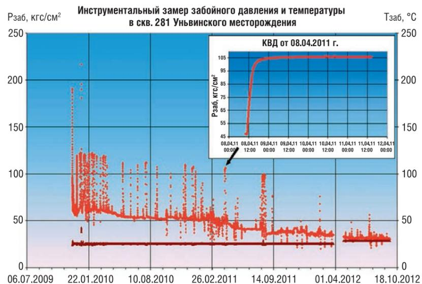
РИС. 3. Инструментальные замеры давления по нижнему объекту в скважине эксплуатирующей одновременно раздельно два объекта
