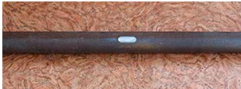
РИС. 11. Моделирование внешнего дефекта 100x20x1,5 мм в 73 мм НКТ с толщиной стенки 5,25 мм
