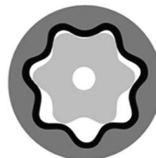
РИС. 5. Схематичное изображение разреза профилированного ВЗД. Эластомер имеет постоянную толщину, что позволяет значительно увеличить крутящий момент на долоте и увеличить срок службы ВЗД
