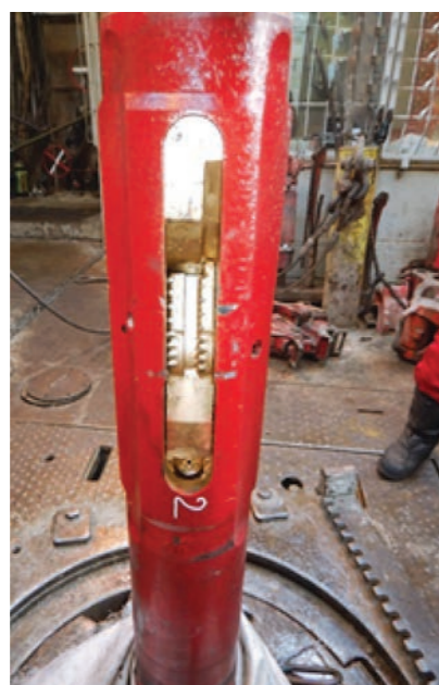
РИСУНОК 3. Внешний вид расширителя и износ вооружения блока резцов до и после рейса
