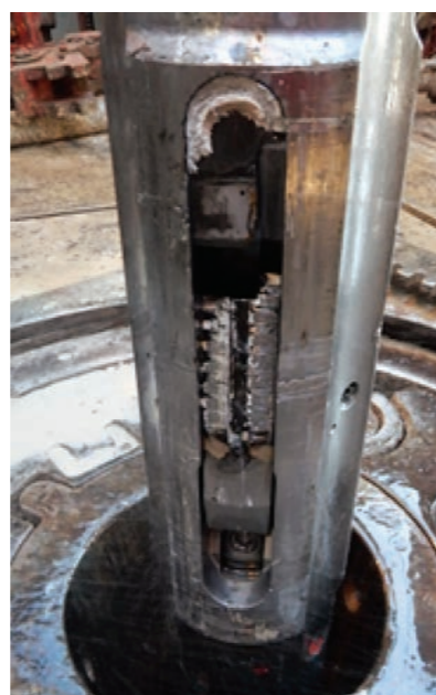
РИСУНОК 3. Внешний вид расширителя и износ вооружения блока резцов до и после рейса
