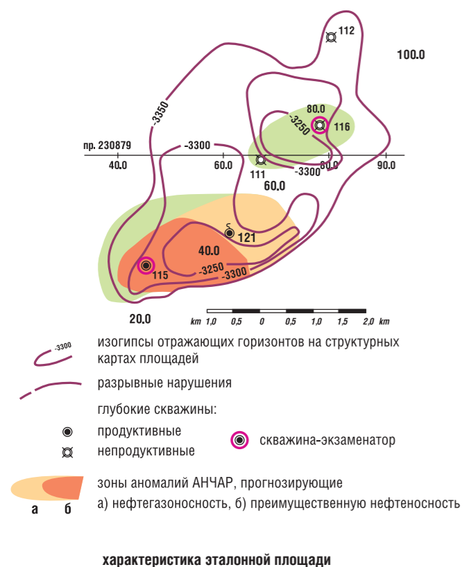
РИС. 4. Вариант полевых работ по прогнозу нефтегазовых залежей ДШП-методом
