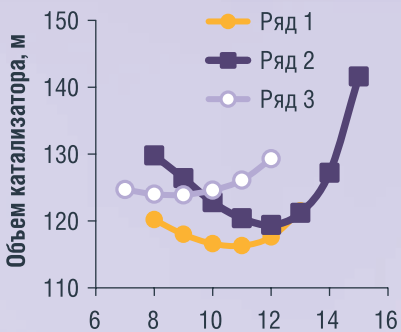
РИС. 6. Зависимость объема катализатора, загружаемого в блок, от номеров узких фракций сырья реактора Р-3: ряд 1 – узкие фракции 8...13, ряд 2 – узкие фракции 8...15, ряд 3 – узкие фракции 7...12
