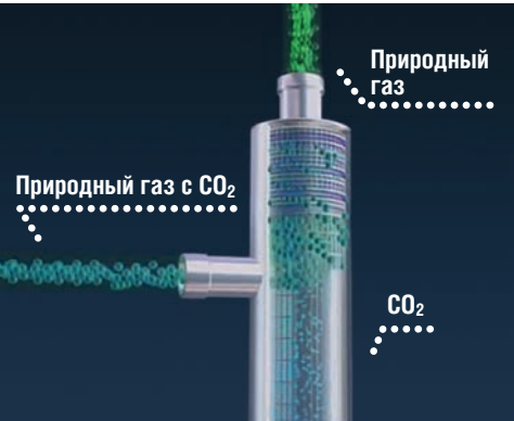
РИС. 4. Отделение ПНГ от углекислого газа
