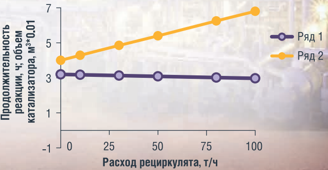
РИС. 2. Зависимость продолжительности реакции (ряд 1) и объема катализатора (ряд 2) от расхода рециркулята при остаточной концентрации серы в дизельном топливе 10 мг/кг
