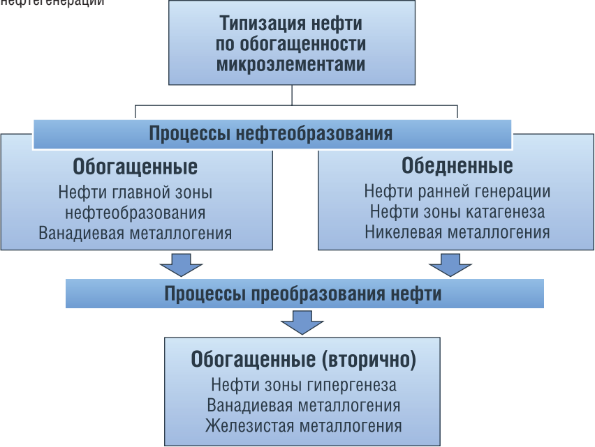
РИС. 1. Схема обогащенности нефтей микроэлементами в зависимости от процессов нефтегенерации
