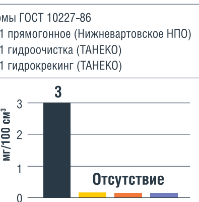
РИС. 4. Концентрация фактических смол, мг/100 см³ в образцах топлива ТС-1
