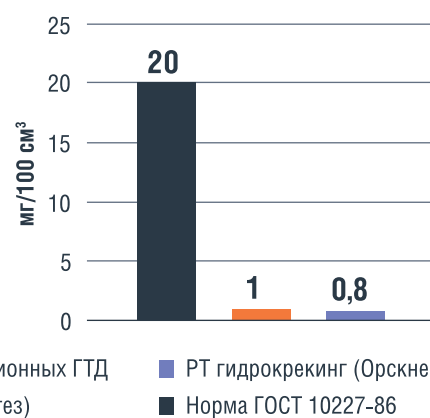
РИС. 10. Термоокислительная стабильность по ГОСТ 11802, мг/100 см³ в образцах топлива РТ
