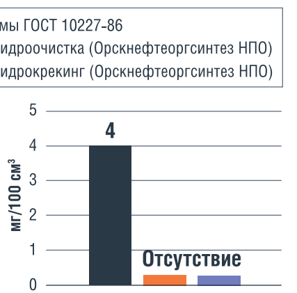
РИС. 8. Концентрация фактических смол, мг/100 см³ в образцах топлива РТ
