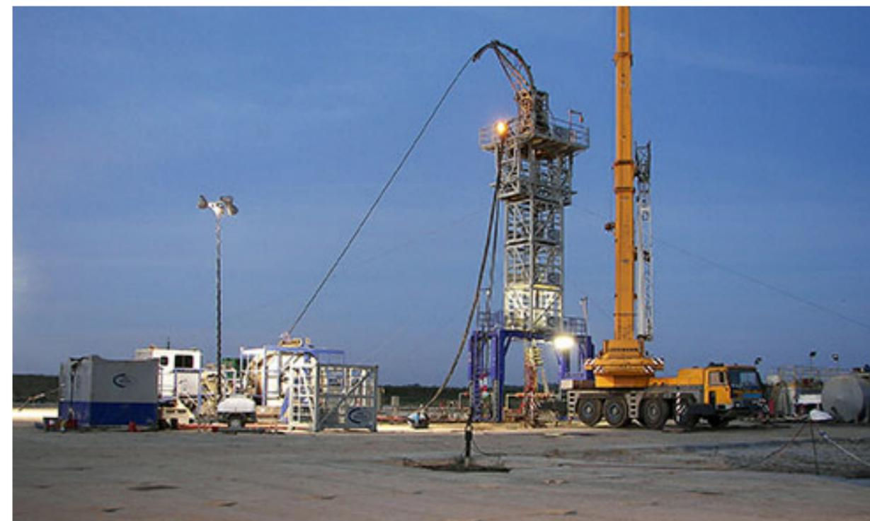
Комплекс койлтубинг и дополнительное оборудование для проведения пескоструйной перфорации
