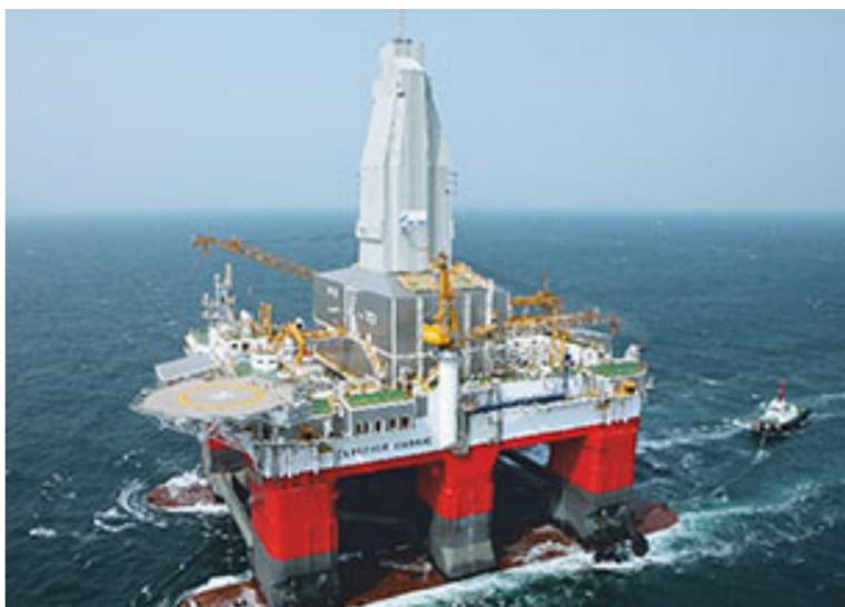
РИС. 3. Полупогружная плавучая буровая установка
