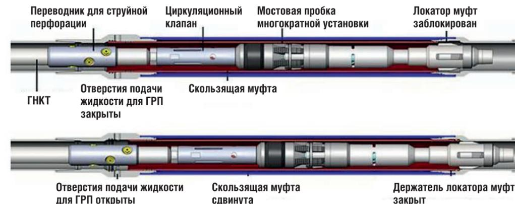
на гибкой трубе и используется для смещения скользящих муфт в положение «открыто» отверстий для закачивания жидкости для ГРП, а также для герметизации нижележащих горизонтов.
