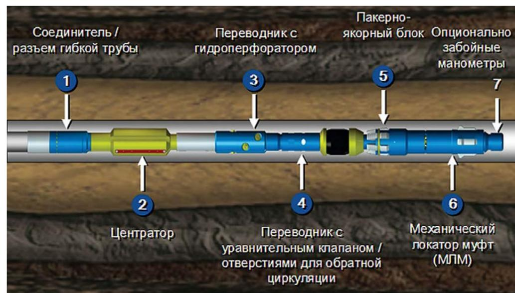
РИС. 3. Схема компоновки системы Mangust
