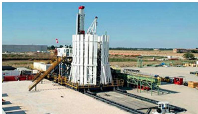
РИС. 1. Автоматизированная буровая установка гидравлического типа НН-300
