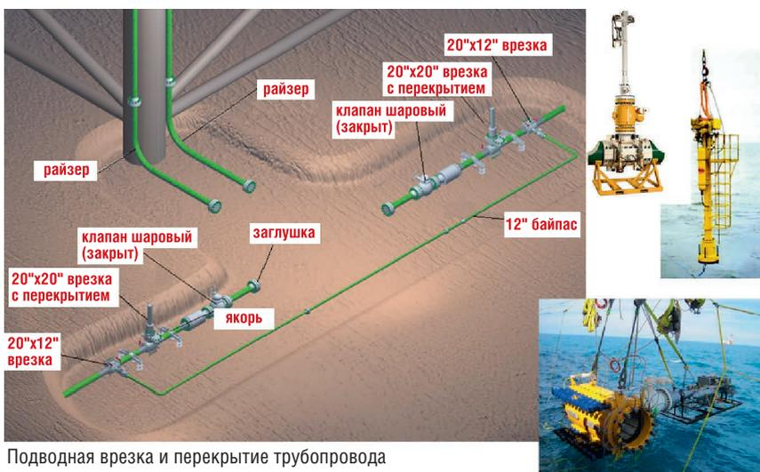
Подводная врезка и перекрытие трубопровода под давлением
