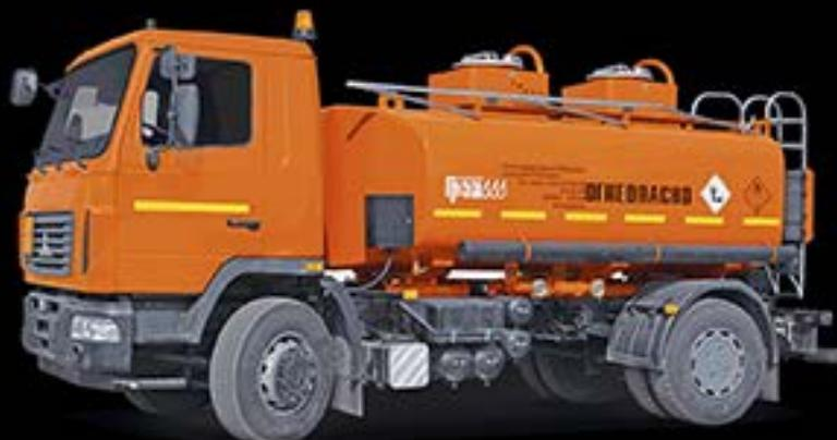
**Топливозаправщик АТЗ 56142** предназначен для транспортировки, кратковременного хранения и заправки светлыми нефтепродуктами плотностью не более 0,83 т/м<sup>3</sup> и является мерой полной вместимости.
