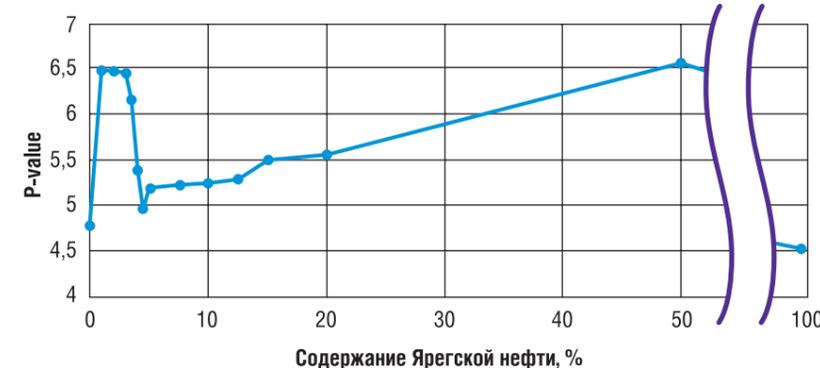
Опыты по микроволновой обработке тяжёлой нефти и её смеси с лёгкой проведены в микроволновой печи Elenberg выходной мощностью 600 Вт при интенсивной циркуляции воздуха в системе. Образцы подвергали микроволновому излучению в течение 5 мин. Следует отметить, что при использовании СВЧ и УЗ нельзя исключить дополнительное влияние нагрева на нефть.
