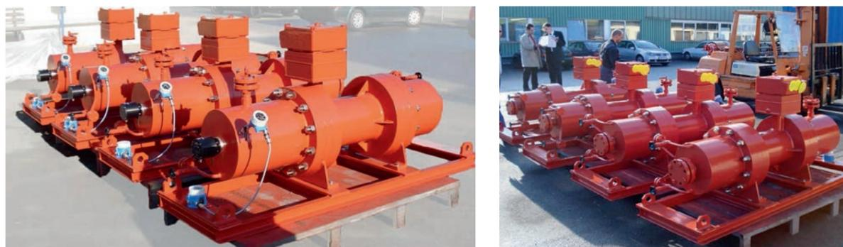
конструкции, отсутствию сальниковых уплотнений, исполнению в соответствии с высокими требованиями международных стандартов и норм EN ISO 22858, ISO 2858 и API 685, насосы HERMETIC обеспечивают высокопроизводительное перекачивание различных сред.
