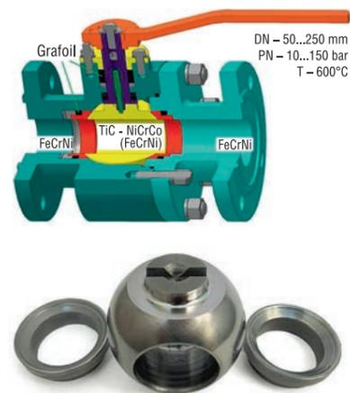
Два таких шаровых крана DN50 с затвором из кермета TiC-Me на основе карбида титана стоят уже более года, проходят опытную эксплуатацию на установке гидрокрекинга Уфимского НПЗ со средними условиями (среда – смесь нефти с соленой водой и песком до 5%, температура 160...200 С, давления 16...20 атм.); число циклов срабатывания за этот период составило 3000...3100, течи среды нет. Зарубежные аналоги арматура MOGAS и ARGUS.
