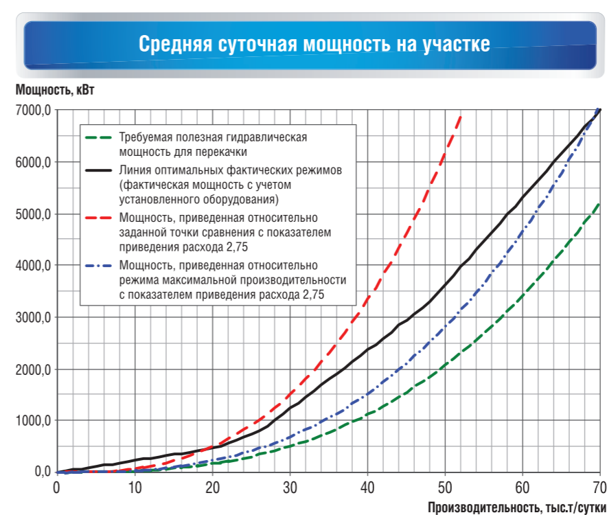
РИС. 5. Планирование требуемой насосной мощности
