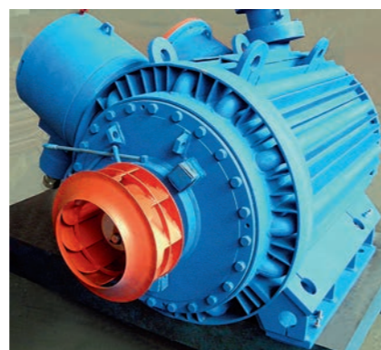
РИС. И ФОТО 3. Одна из конструктивных особенностей двигателя – вентилятор нового типа
