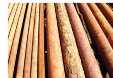
РИС. 2. Наружная коррозия обсадных труб
