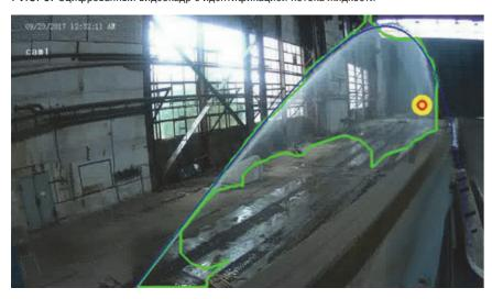
В результате достигнута хорошая степень совпадения реальных и расчётных траекторий струй. Расчетные траектории могут использоваться как для определения зон орошения, так и для определения угла наведения по заданным координатам. Программа «Баллистика», приведенная на сайте firerobots. ru, широко используется проектировщиками разных организаций.
