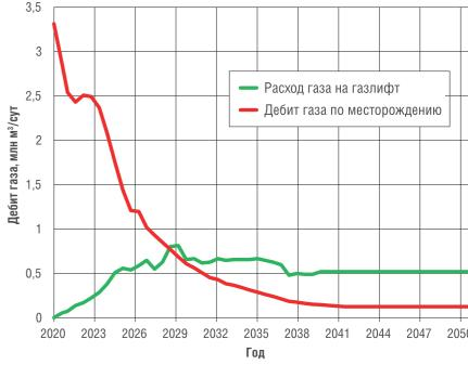
способа добычи приходится на 2032-2038 гг., и варьирует в пределах 0.9-1.1 млн м³/сут. Как следует из прогнозного баланса газа (рисунок 8), пиковая потребность газа для газлифта приходится на период резкого снижение уровня добычи газа, что предполагает привлечение дополнительных объемов газа других объектов разработки или месторождений.
