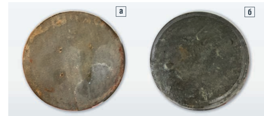
РИСУНОК 3. Цементный камень до (а) и после (б) испытания (составлен авторами)
