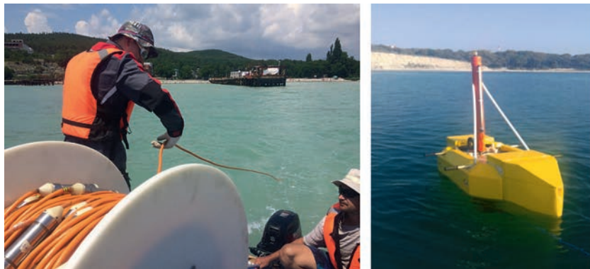
РИС. 4. Испытания автономной донной секционной сейсмокося в Голубой бухте, 2018 г.
