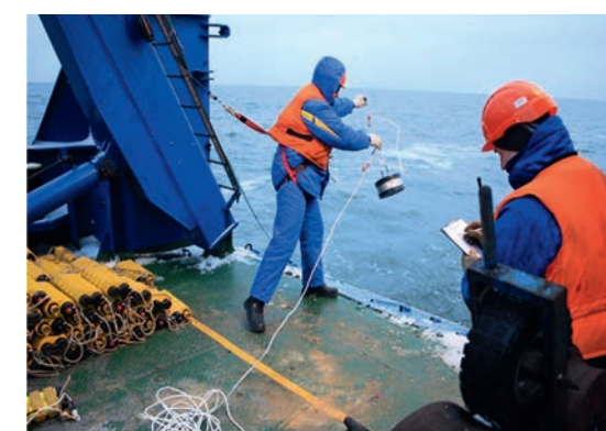
РИС. 3. Раскладка опытных автономных донных регистраторов на профиле
