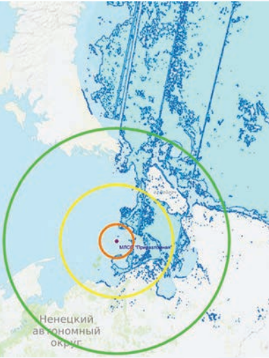
РИС. 4. Определение границы распространения ледяных полей в предлагаемых зонах мониторинга района функционирования МЛСП «Приразломная», классификация по типу «лед-вода» (Печорское море, июль 2018 года)
