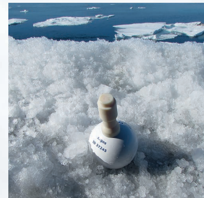
РИС. 3. Радиомаяк-трекер системы ARGOS для отслеживания перемещения ОЛО
