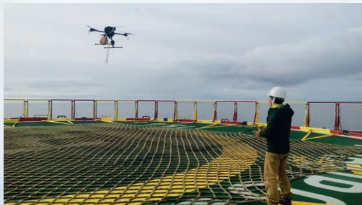
РИС. 6. Запуск БПЛА с радиомаяком-трекером
