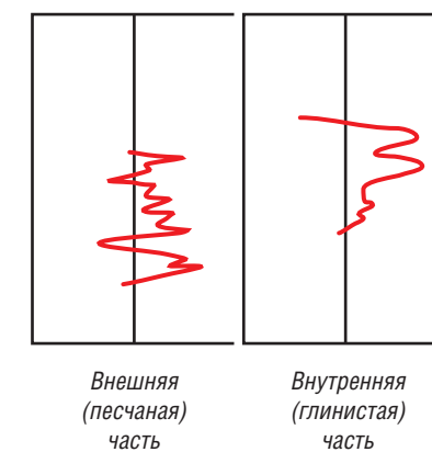
РИС.2б. Электрометрические модели пойменных отложений
