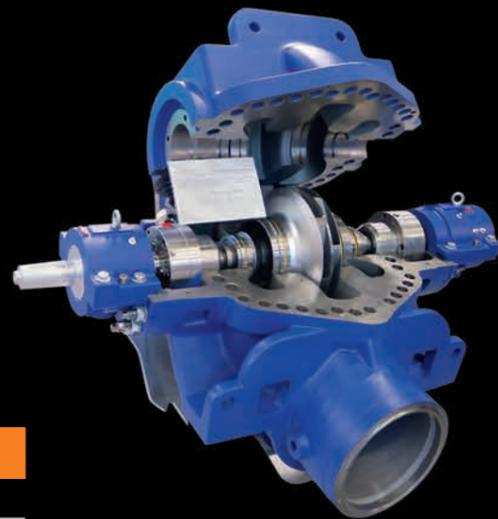
Насос центробежный, одноступенчатый, межопорный, с колесом двухстороннего входа, с осевым разъемом корпуса, типа ВВ1 по ГОСТ 32601.
