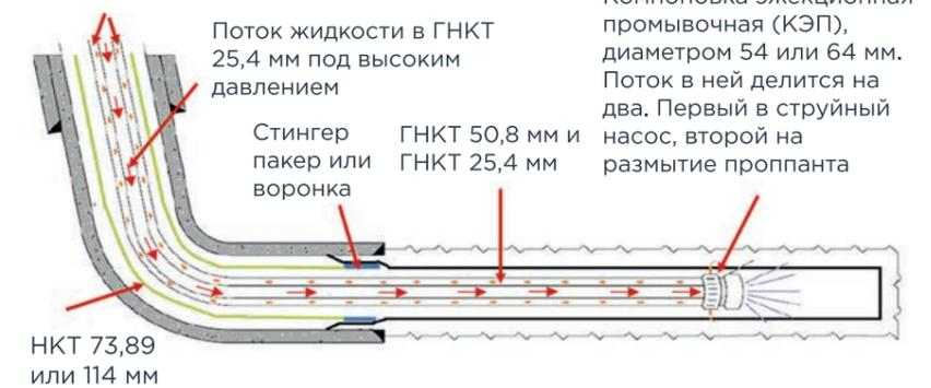
РИСУНОК 3. Схема работы КЭП-54
