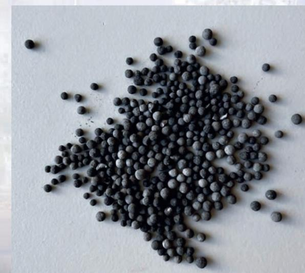
зависящего от фракционного состава гранул. В зависимости от времени пропитки достигается различная глубина проникновения активного компонента в объем носителя. Так, для гранул оксида алюминия сферической формы с диаметром 2–3 мм оптимальное время пропитки составляет 6 часов. При неполной пропитке носителя раствором активного компонента в процессе пиролиза коксообразование преимущественно протекает внутри непропитанной области гранул катализатора, что приводит к потере его активности.
