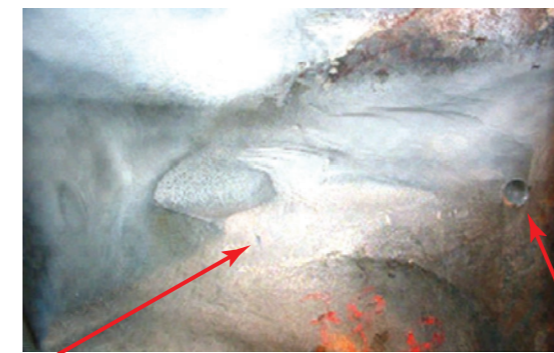
Место сверления Ø 18 мм глубина 2,0 мм Место сверления Ø 18 мм глубина 8,46 мм
