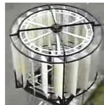
РИСУНОК 1а. Конструкция ветротурбинной установки модульного типа
